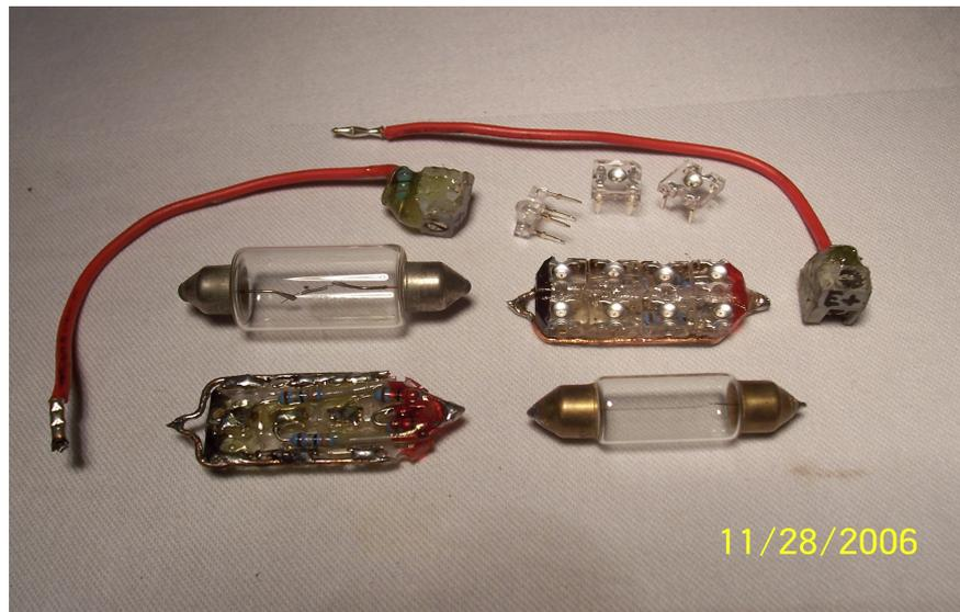
Diese rot abstrahlenden Superflux-LED's werden über Vorwiderstände mit ca. 2,5 V bei 50 mA – 60 mA je LED betrieben. Außerdem sind diese Superflux-LED StVZO konform in Form der Abstrahlung sowie der Farbtemperatur.
