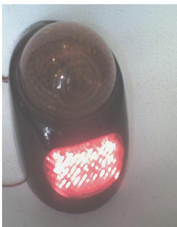
Ein Test hat gezeigt, dass die Leuchtkraft dieser Anordnung als Brems- und Schlussleuchte intensiver als bei Glühlampen ist – der Stromverbrauch liegt bei einem 6 Volt-LED-Block mit 8 LED's bei gerade mal **0,45 A** im Bremslicht - und ca. **0,15 A** im Schlusslichtbetrieb, ohne nennenswert Wärme abzustrahlen, was auch nicht zu verachten ist (Lampe 6 V/21W=3,5A ! Und Abstrahlung großer Wärme, welche oft das Pertinax der Fassungen zerstört).
